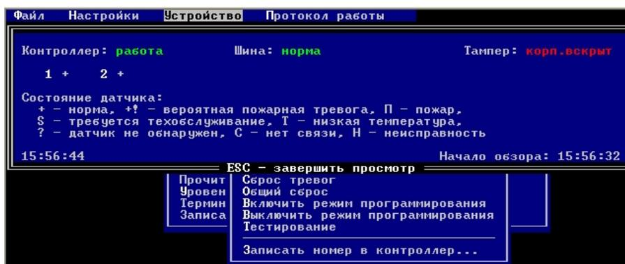
Рис. 57. Отображение состояния контроллера РСС и извещателей СС.
