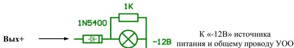
Рис. 26. Схема подключения шлейфа КЦО.
