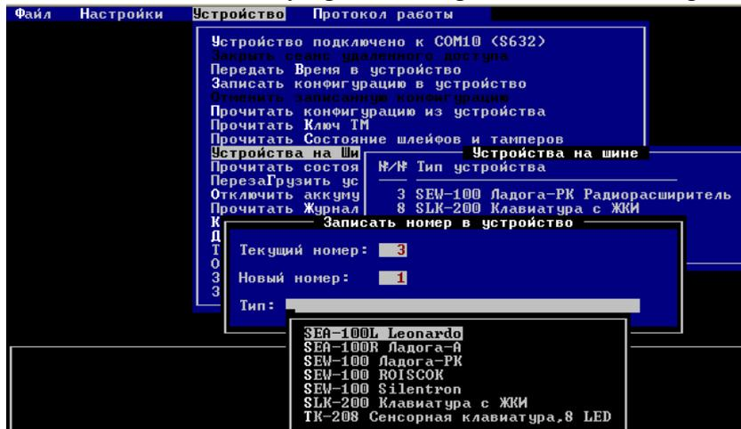
Рис. 54. Запись номера в контроллер устройства.
