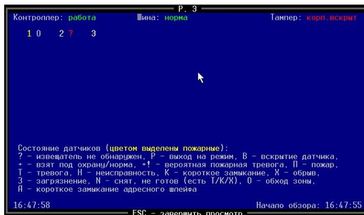
Рис. 61. Чтение состояния расширителя.
