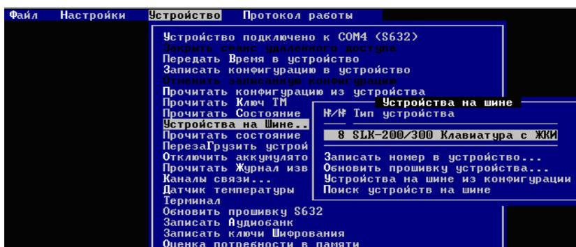
Рис. 53. Отображение устройств, подключенных к шине ППКОП.
