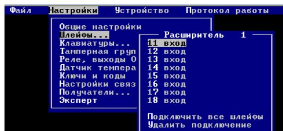
Рис.19. Подключение ШС к входам к входу 2 - расширителя на 1 входе ППКОП
