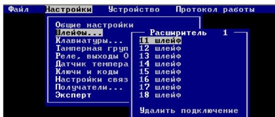
Рис 20. Ко всем входам расширителя 1 подключены шлейфы
