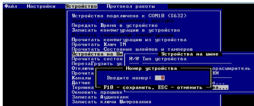
Рис. 55. Запрос номера устройства при записи прошивки.
