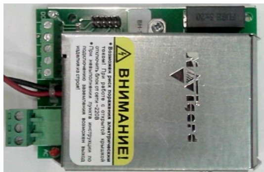
NV 7220 Импульсный источник бесперебойного питания
