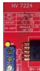
NV 7224 Модуль контроля и защиты АКБ
